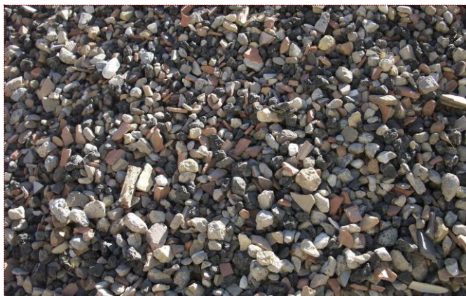
Ilustración 6 Árido reciclado mixto.
