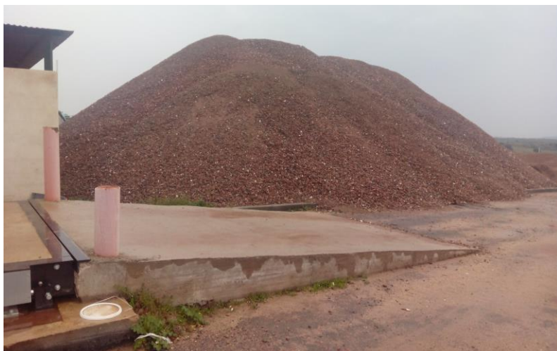
Ilustración 7. Acopio de árido reciclado en una planta de reciclaje de RCD.
